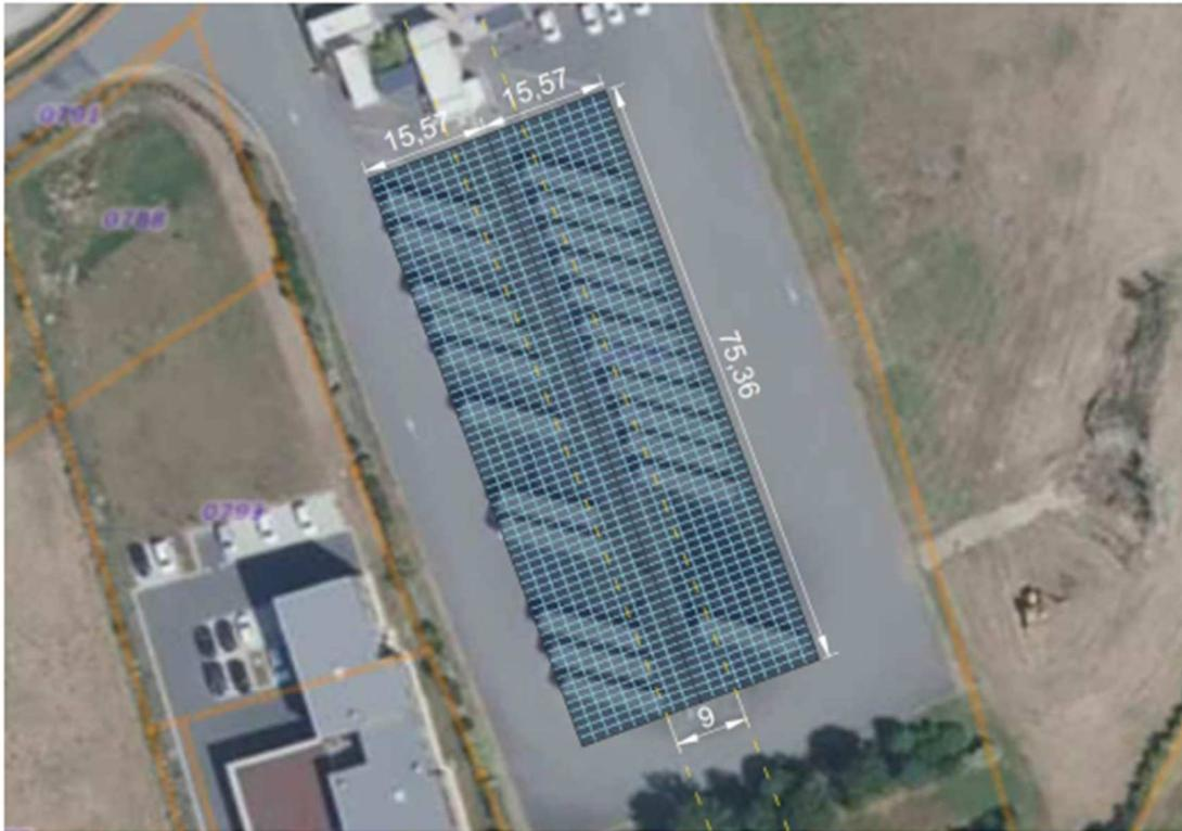
Figure 2 - Plan de calepinage du parking
