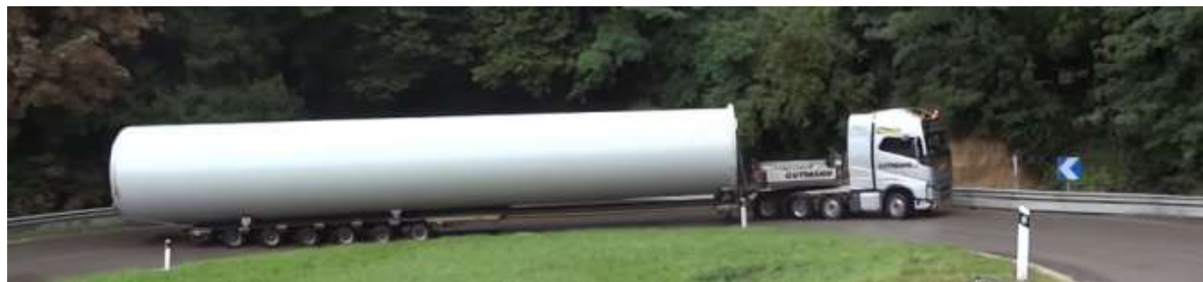
Figure 8 : Transport d'une section de mât
